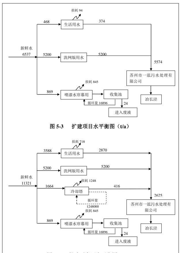
图 5-4 扩建后全厂水平衡图(t/a)
