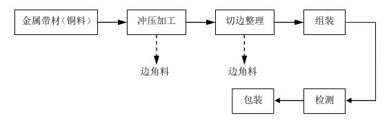
图 1-1 现有项目生产工艺流程图
