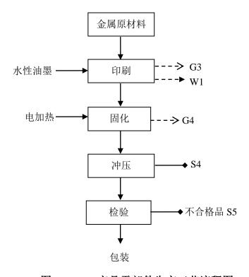
图 5-2 3C 产品零部件生产工艺流程图
