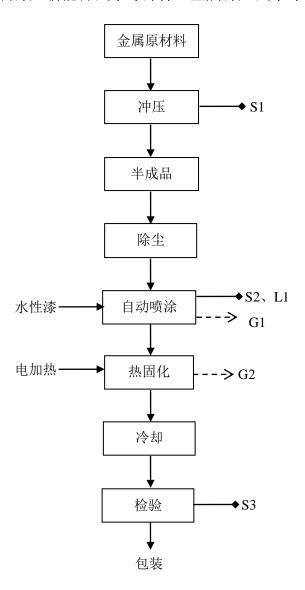
图 5-1 太阳能瓦片、金属冲压新能源汽车零部件、金属冲压汽车零部件生产工艺流程图 流程说明:
