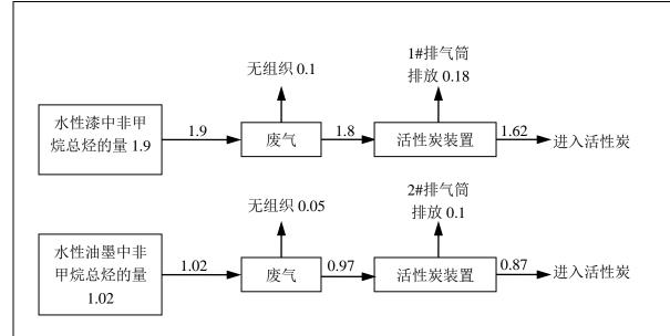
图 5-5 非甲烷总烃平衡图 单位: t/a
