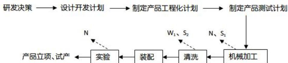
图 2-6 研发中心工作流程图
